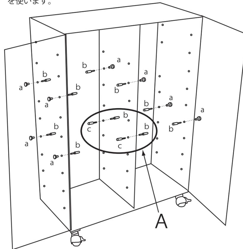
5. 棚板の凹と固定具の凸を合うように載せます。通常は棚板と背板が隙間無く揃う方向で使用し、配線などを背面ケーブル穴に通す場合は棚板の向きの前後を反転して使用します。
