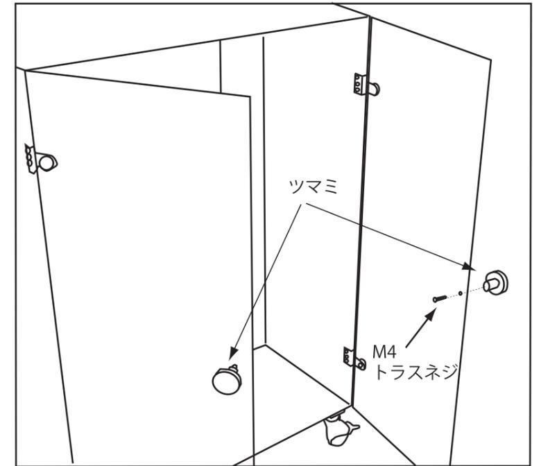
3. ドアを閉めた状態で本体とドアにズレがある場合は、ドア内側のネジをプラスドライバーで緩め、適正位置に調整後に再度ネジを締めます。(緩まない程度に締めます)
