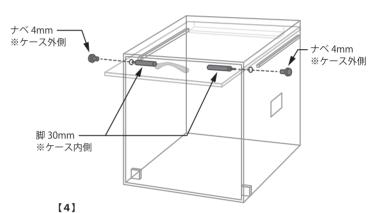
ガイドレールの手前にある 2 カ所の穴に、ナベ 4mm がケース外側、脚 30mm がケース内側にくるようにして、緩みがないように取り付けます。 扉を上側に押し上げながら作業すると、ネジが取り付けやすくなります。
